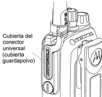
Coloque el sujetador de la cubierta del conector universal sobre la antena instalada. Deslícelo completamente hacia abajo hasta la base de la antena.
